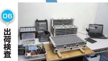
集塵電極の変形・イオン化線確認・絶縁チェック
