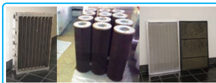
使用中の汚れた空調機フィルター
