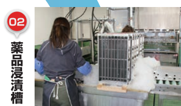
軟水を使用した無リン弱アルカリ洗浄液への漬槽
